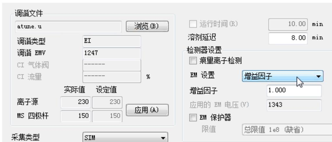
检查完质谱参数后，同样点击下方的“确定”即可在当前仪器软件上完成对采集方法的调用，最后记得保存方法。
