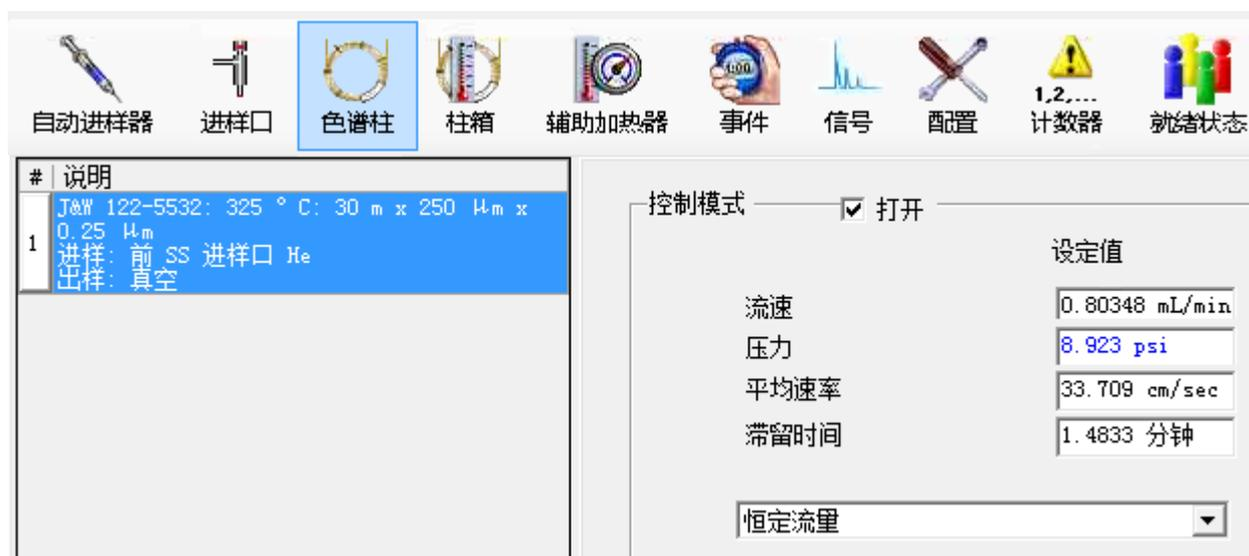
同样可将所得新的进样口压力值8.923 psi或者柱流速值0.80348 mL/min设置到带有SIM参数的GBT 5009.146-2008采集方法中，其余参数保持不变，这样即可在当前仪器状态下使化合物的实际RT仍与法规中参考RT相匹配。
