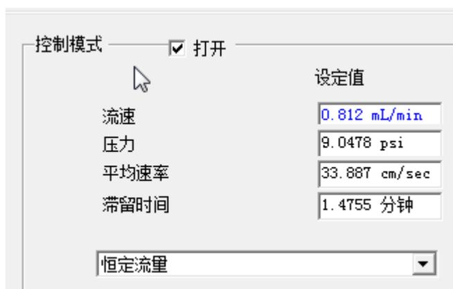
随后可将所得的进样口压力值9.0478 psi或者柱流速值0.812 mL/min设置到所下载的带有SIM参数的GBT 5009.146-2008采集方法中，方法的其余参数保持不变，这样即可在当前仪器上建立起化合物实际RT与法规中参考RT相匹配的多农残SIM采集方法。
